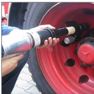
De makkelijk verstelbare cup steunt af op een nabijgelegen moer en voorkomt beschadiging van de velg.
