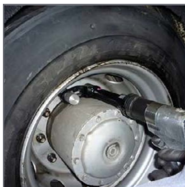
Met de HYTORC Wheelgunarm zijn ook diepgelegen wielbouten eenvoudig te bereiken.
