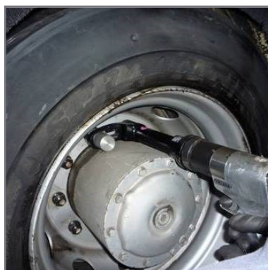
Avec le HYTORC Wheelgun-bras de reaction les boulons de roue profondes sont accessibles facilement
