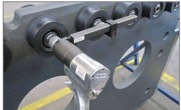
TPF avec vis CHC et iGUN sur presse plieuse.
