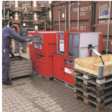
Système de nettoyage entièrement automatique pour le nettoyage rapide de grandes quantités aux arrêts.
