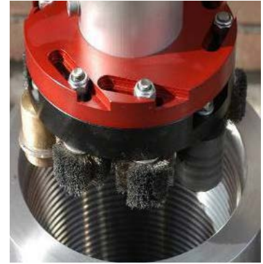
Nettoyage mécanique du filetage interne avec différentes brosses.
