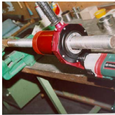
Ein BoltClean mit seitlichem Antrieb für die komplette Reinigung von langen Bolzen.
