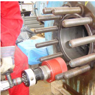
BoltClean in Aktion. Stehbolzen und Bolzen werden schnell und einfach gereinigt.
